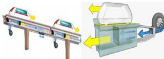
Şəkil 6. Aeromovel texnologiyasının hərəkət sistemi
