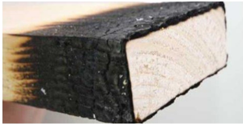
Şəkil 1. Yanmış oduncaq konstruksiyası hissəsinin görünüşü
