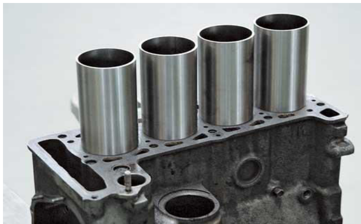
Şəkil 2. Blokda gilizlərin yerləşdirilməsi
