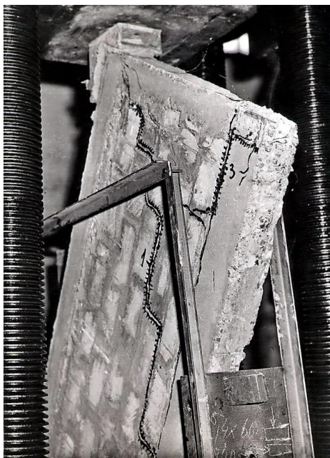
Şək. 2 Karkas gözü sınaq nümunəsinin sınaqdan sonrakı görünüşü
